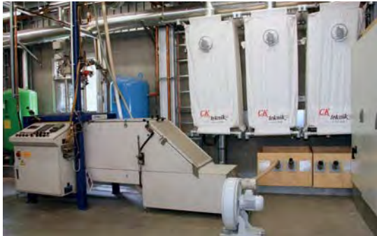
Abbildung 130: Chargenvorschäumer PRO-A-500 der Fa. STYRO-LOGIC am FRAUNHOFER IFAM (COPYRIGHT) in Bremen
