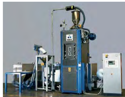
Abbildung 129: Diskontinuierlicher Vorschäumer der Firma KURTZ (COPYRIGHT)
