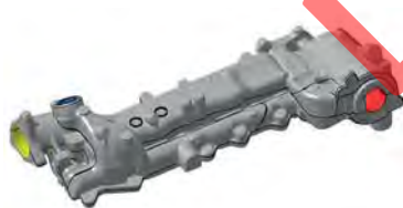
Abbildung 14: Konstruktion eines Ladeluftverteilers (oben) mit Führung von Ladeluft, Abgas und Wasser (Mitte) und zerlegtes Konstruktionsmodell in die einzelnen Segmenten (rechts) (COPYRIGHT: ALBERT HANDTMANN METALLGUSSWERK GMBH & Co.KG )
