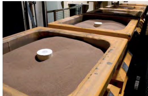
Abbildung 100: Eingeförmte Modelltraube in Quarzsand (6-Zylinder-Zylinderköpfe der BMW GROUP (COPYRIGHT))
