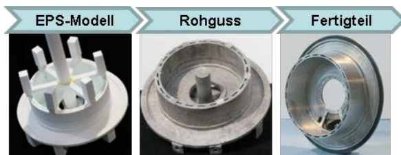
wassergekühlter Stator für den Fraunhofer Radnabenmotor – hergestellt im Aluminium Lost Foam Gießverfahren
