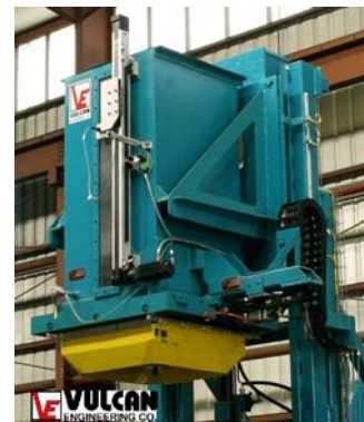
Sand Fill Hopper
